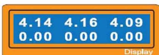
Если батарея подсоединенна к балансиру зарядного устройства (на правой боковой стенке ЗУ), то можно наблюдать изменения напряжения на каждом элементе в режиме реального времени. Балансир позволяет контролировать до 6 элементов.
